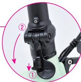
ロックボタンを引き上げながら、ステム折りたたみレバーを下ろすと、ハンドル部分を倒せます。展開時には、レバーがロックされている事をご確認ください。
