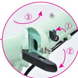
ロックカバーを上回転させながらフレーム折りたたみレバーを外側に開くと、フレームが中央から折れます。展開時にロックカバーを被せたことを確認し、レバーを確実に固定してください。
