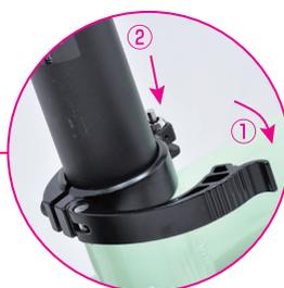
ロックが解除されていることを確認しシートクランプを緩め、シートポストが地面につくまでサドルを降ろします。乗車時の目盛りを覚えておくと、展開時に高さ調整が容易になります。
